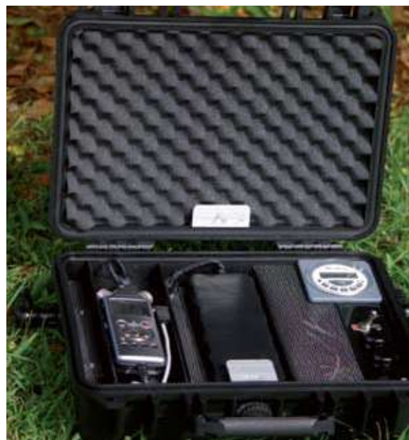
Fig. 3: The recorder based on the Olympus LS-11, with large external battery, timer and AGC card all housed in a waterproof case. L'enregistreur est composé d'un Olympus LS-11 avec une grosse batterie externe, un chronomètre et une carte AGC placés dans une valise étanche
