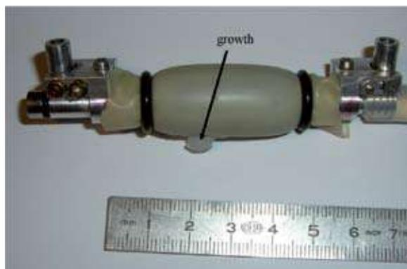
**Fig. 8 :** Photo de l'une des réplique de plis vocaux avec une excroissance artificielle collée
