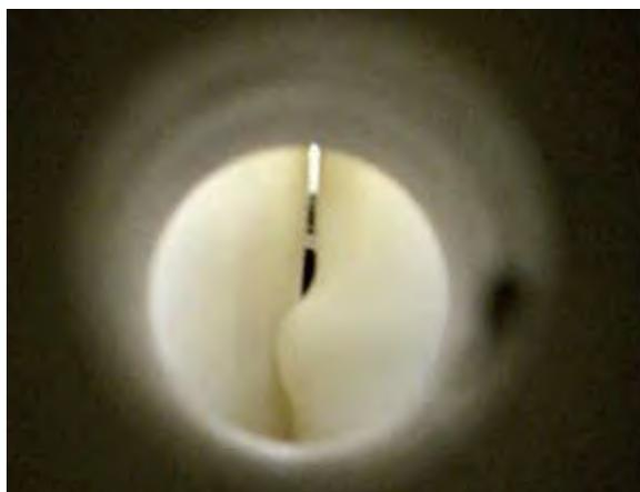
**Fig. 9 :** Photo de la glotte de la maquette de pli vocal avec une excroissance artificielle sur son côté droit.
