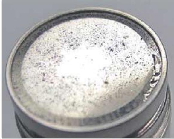
**Fig. 17 : Grande coupure sur le bord du microphone**
