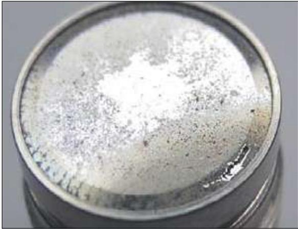
**Fig. 15 : Petite coupure sur le bord du microphone**
