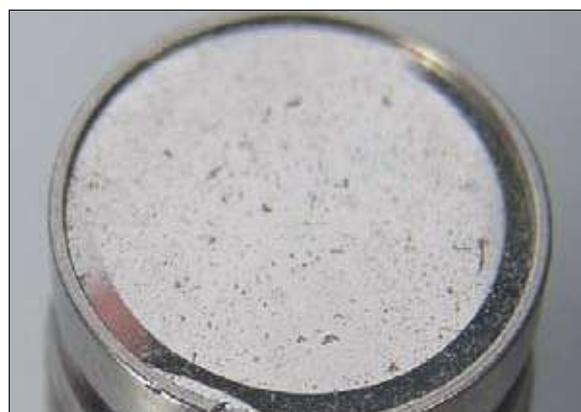
**Fig. 13 : Coup sur le bord du microphone**
