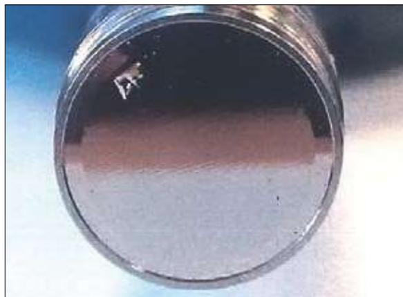
Fig. 1 : Microphone avec sa membrane endommagée
