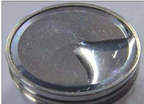
**Fig. 7 : Goutte d'eau sur la membrane**
