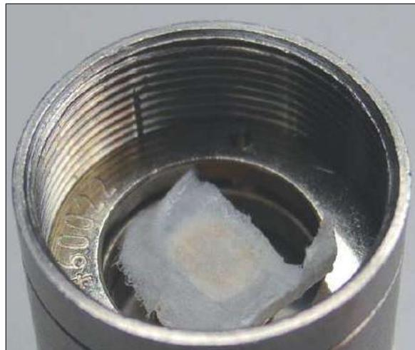
**Fig. 19 : Papier fin humidifié sur le connecteur du microphone**
