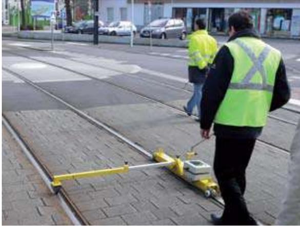
Fig. 3 : Mesure de la rugosité des rails à l'aide d'un chariot mobile
