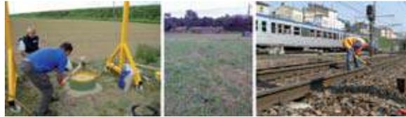
**Fig. 3 :** Mesures sur site : à gauche, charge impulsionnelle par impact de marteau pour une caractérisation de sol par méthode MASW, au centre, distribution d'accéléromètres en champ libre pour une caractérisation de sol par méthode MASW, à droite, charge impulsionnelle sur le rail pour une mesure de réceptance de voie
