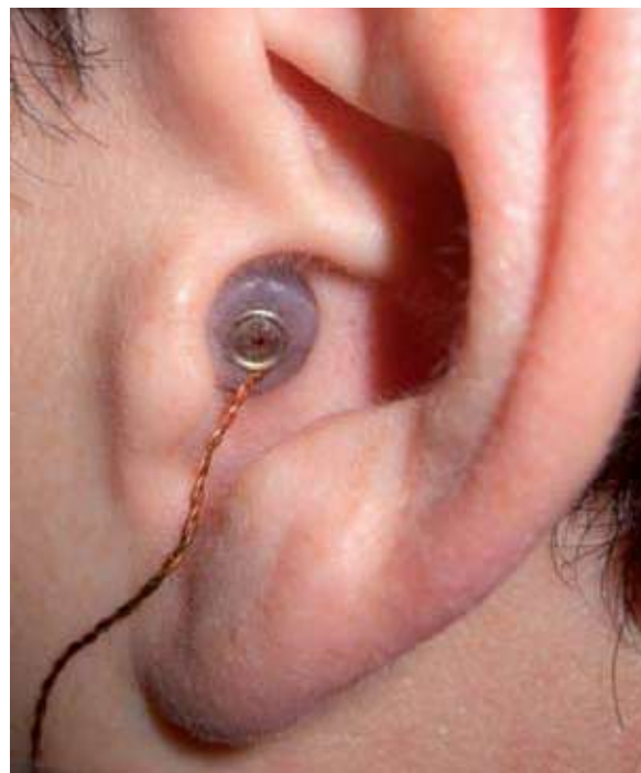
Fig. 2 : L'image de gauche montre l'automate de mesure des HRTFs dans la chambre semi-anéchoïque de l'Institut de recherche biomédicale des Armées. L'image de droite illustre le placement d'un microphone selon la technique « conduit bloqué ».
