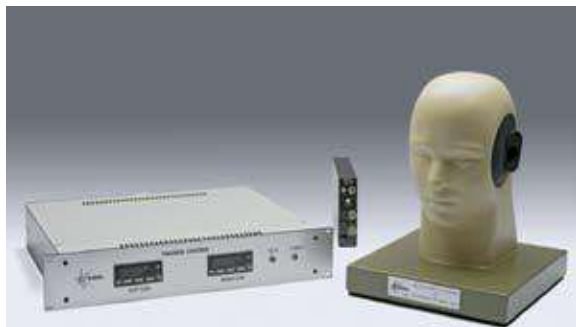
Fig. 8 : Tête artificielle acoustique ISL conforme à la norme ANSI/ASA-S12.42-2010
