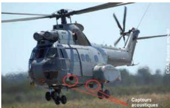
Fig. 5a : Essais de tir sur Puma muni de capteurs acoustiques
