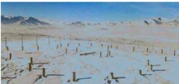
Fig. 7 : Élément central de la station infrasons IS34 installée en Mongolie. Le capteur est placé dans une buse, au centre d'un système de filtrage acoustique atténuant le bruit lié aux turbulences atmosphériques locales. Cette station enregistre la houle de l'Atlantique Nord à plus de 10 000 km de distance
