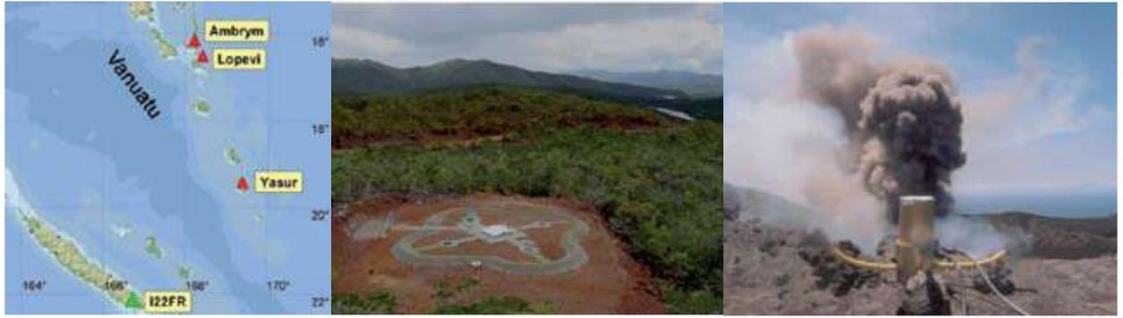
Fig. 5 : À gauche, carte montrant le positionnement de la station IS22 (au milieu) installée en Nouvelle-Calédonie par rapport aux volcans actifs du Vanuatu détectés en permanence. À droite, le volcan Yasur. Un microbaromètre est placé sur la bouche du cratère pour mesurer le terme source
