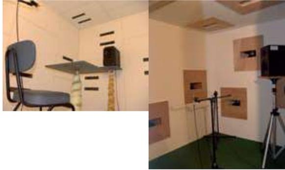
Photos 1 : Vue intérieure de la cabine de simulation (gauche) sans la laine de roche / (droite) complètement terminée
