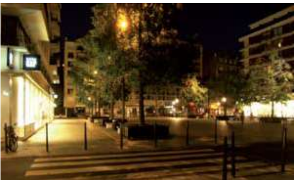
Fig. 3 : L'essentiel de l'éclairage (50 lux) de cette partie de la place est assuré par l'éclairage des vitrines
