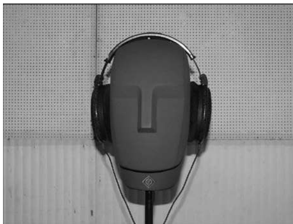
Fig. 1 : Casque Sennheiser HD600 posé sur la tête Neumann KU 100
