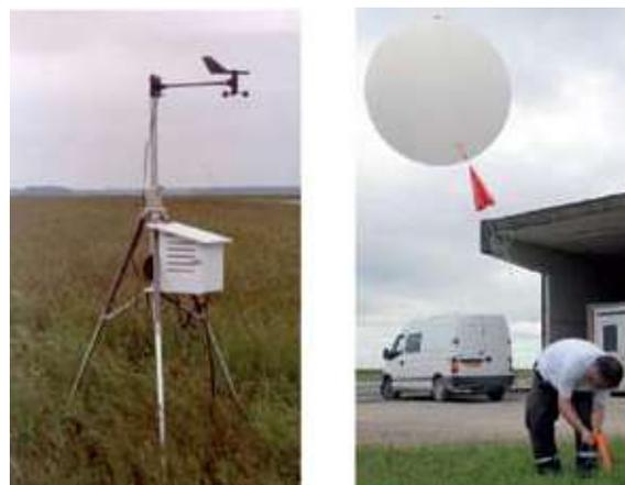
Fig. 4 : Station météorologique au sol complétée par le lâché d'un ballon-sonde
