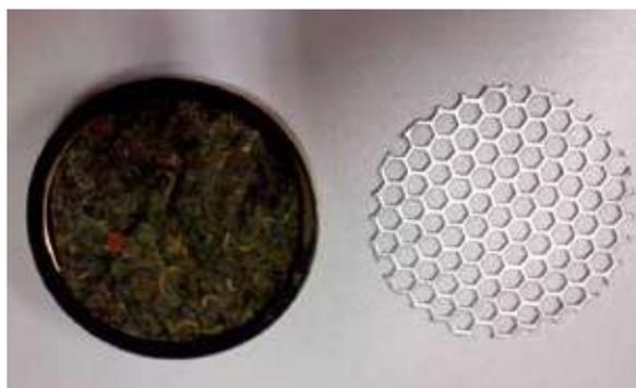
Fig. 4 : Gauche : Couche de poreux dans son porte échantillon. Droite : grille limitant les vibrations du squelette du poreux
