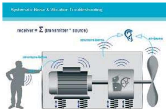
Fig. 1 : Modèle Source-Transmetteur-Récepteur
