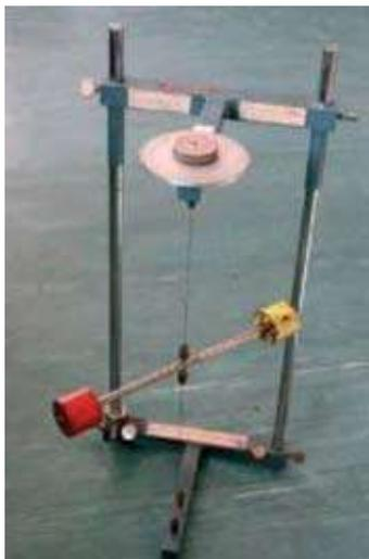
Fig. 8 : Pendule de torsion – oscillation libre
