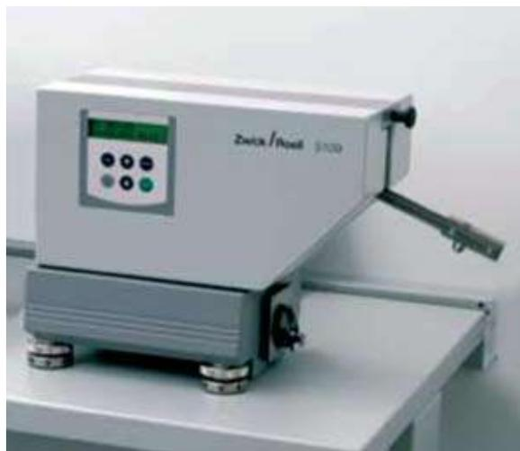
Fig. 7 : Rebondimètre Zwick 5109
