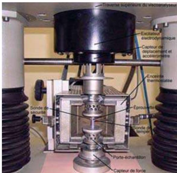
Fig. 15 : Bâti DMA+ 150N (vue détaillée de la colonne de mesure)
