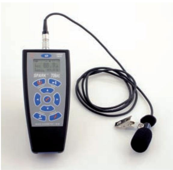
Fig. 2 : Sonomètre intégrateur simple, mais fiable
