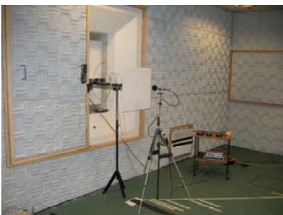
**Fig. 8 :** L'aérateur est placé dans une salle traitée acoustiquement
