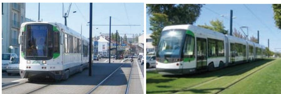
Fig. 1 : Rames et sites de mesure (gauche : rame A – voie DPHI + pavés ; droite : rame B – voie classique + gazon)
