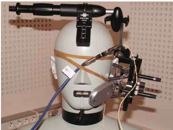
Fig. 1 : Mesure de caractérisation d'un terminal mobile
