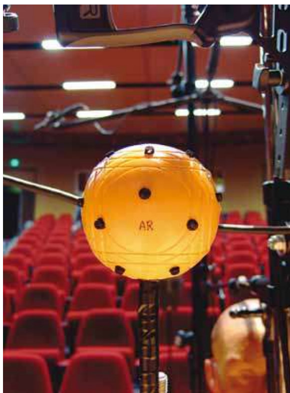
Fig. 2 : Prototype de microphone HOA pour la captation d'une scène audio 3D
