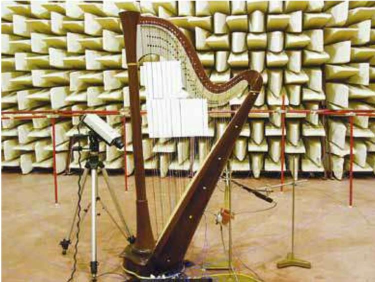
Fig. 1 : Analyse modale d'une harpe par technique de vibrométrie LASER
