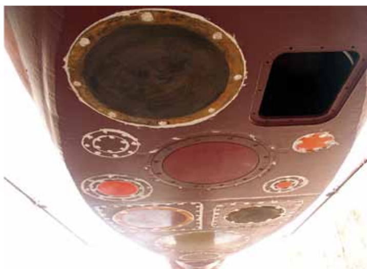
Fig. 1 : Transducteurs sonar installés sous la coque du N.O. Thalassa
