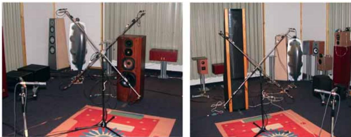
Fig. 1 : Enregistrement de différents modèles d'enceinte dans la salle d'écoute de l'entreprise Mosquito. Ces enregistrements ont ensuite été utilisés lors de tests d'écoute au casque (Lavandier [15])
