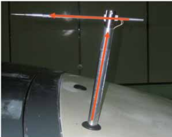
Fig. 9 : Sonde fil chaud montée sur un bras de déplacement, en aval de la césure de hayon
