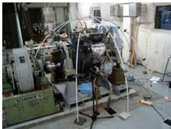
Fig. 1 : Le moteur étudié et le dôme de mesures microphoniques
