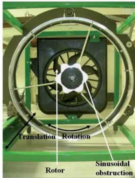
Fig. 3 : Système de positionnement des marguerites
