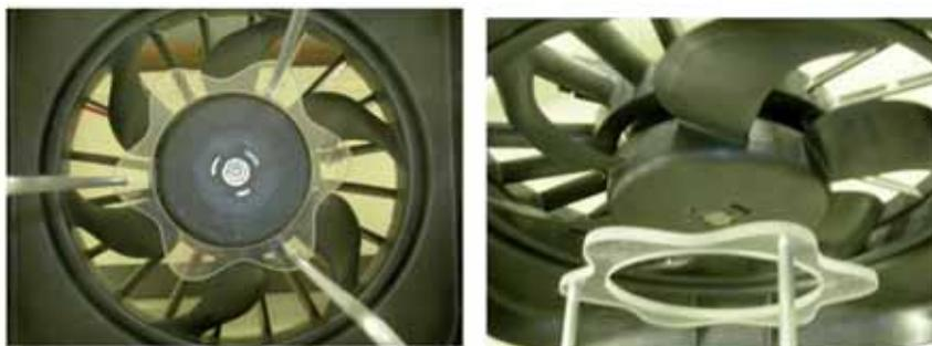
Fig. 5 : Photo de l'obstruction sinusoidale en position optimale. À gauche : vue de l'amont dans l'axe, à droite : vue amont  $3/4$
