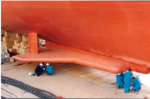
Fig. 4 : Montage de la gondole sous la coque du BHO Beautemps-Beaupré
