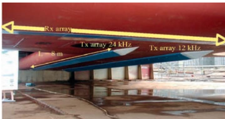
Fig. 9 : Antennes du sondeur multifaisceau grands fonds du NO Pourquoi pas ?
