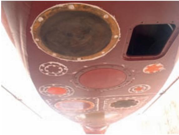
Fig. 3 : Transducteurs sous la coque du NO Thalassa
