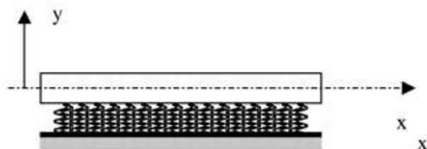
Fig. 7 : Modélisation simplifiée de la voie : poutre sur appuis élastiques continus
