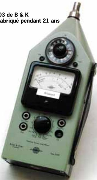
Ces sonomètres de première génération, à affichage analogique, avaient le mérite d'être proposés à des prix attractifs, mais présentaient un défaut important: ils ne permettaient réellement que la mesure des bruits stables et continus.
