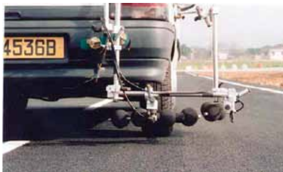
Photo 1 : méthode de mesure de bruit émis par le véhicule sur la chaussée - Photo INRETS.
